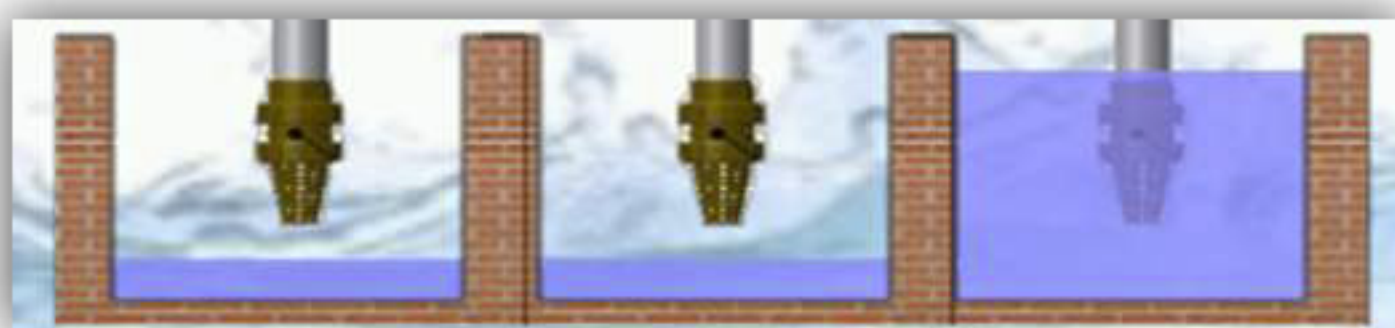
Ejemplo de bajo nivel en la succión del tanque #1 y #2.
